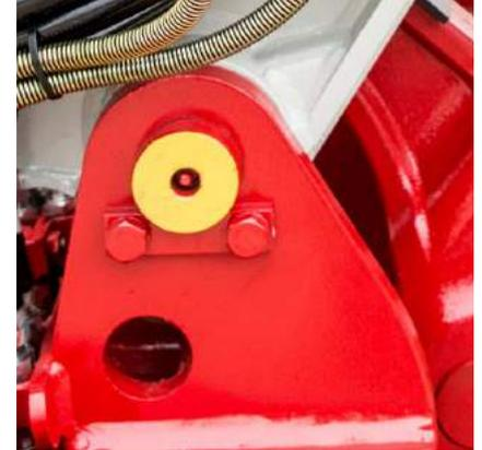
Punti di ingrassaggio ben visibili colorati di giallo. Sistema meccanico di blocco del braccio quando il tutto è spostato a sinistra. Sistema di recupero del gioco dei perni del brandeggio.
