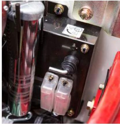
Staccabatteria nel vano motore.
