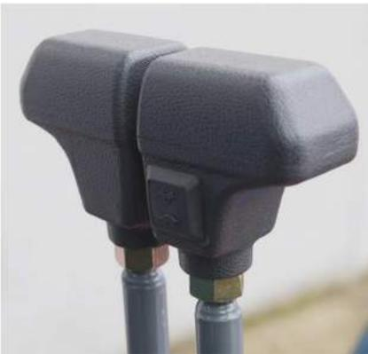
Comando di selezione velocità sulla leva di traslazione destra.
